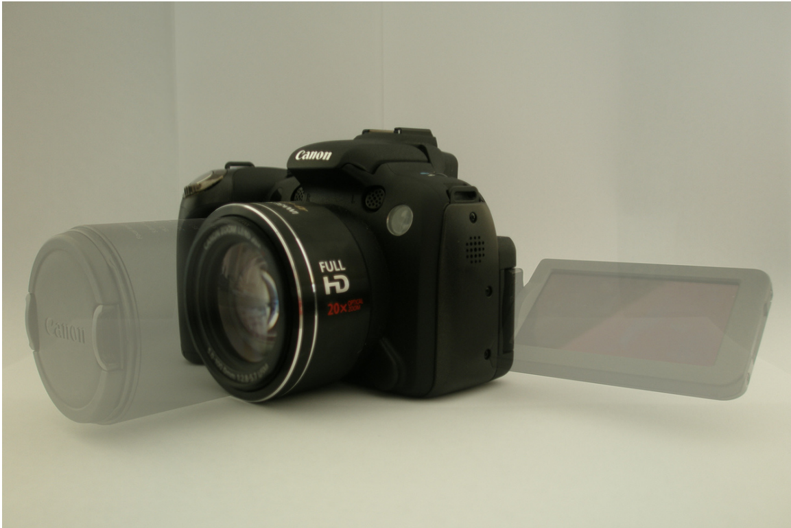
Abb. 188 Eine seinerzeit verbreitete Bridgekamera war die Canon PowerShot SX1 IS. Das Objektiv hat einen großen Zoombereich, kann aber nicht ausgewechselt werden. Außer dem Sucher hat sie einen klapp- und schwenkbaren Bildschirm.
