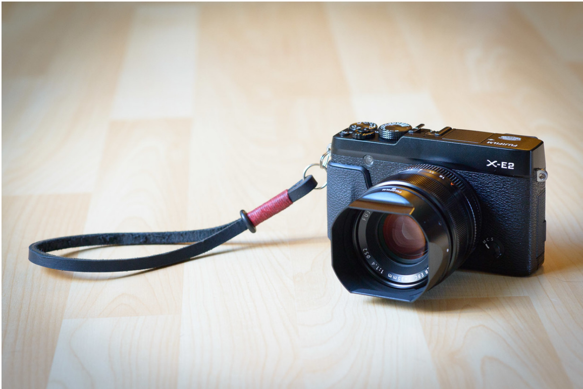
Abb. 189 Ohne Spiegel, aber mit wechselbarem Objektiv: Die Fuji X-E2 ist deutlich kleiner als DSLRs.
