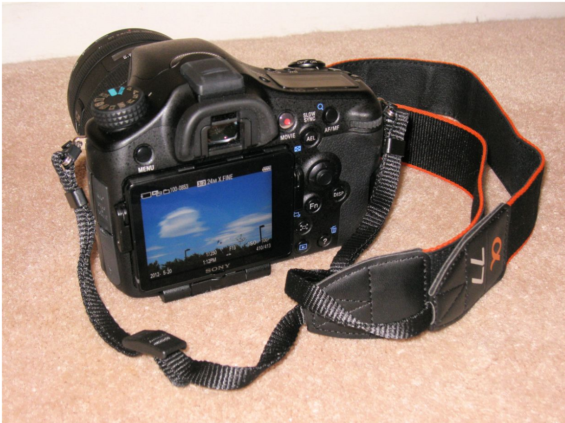
Abb. 193 Rückseite einer Sony Alpha 77, mit eingeschaltetem LCD-Bildschirm und darüber einem Sucher.
