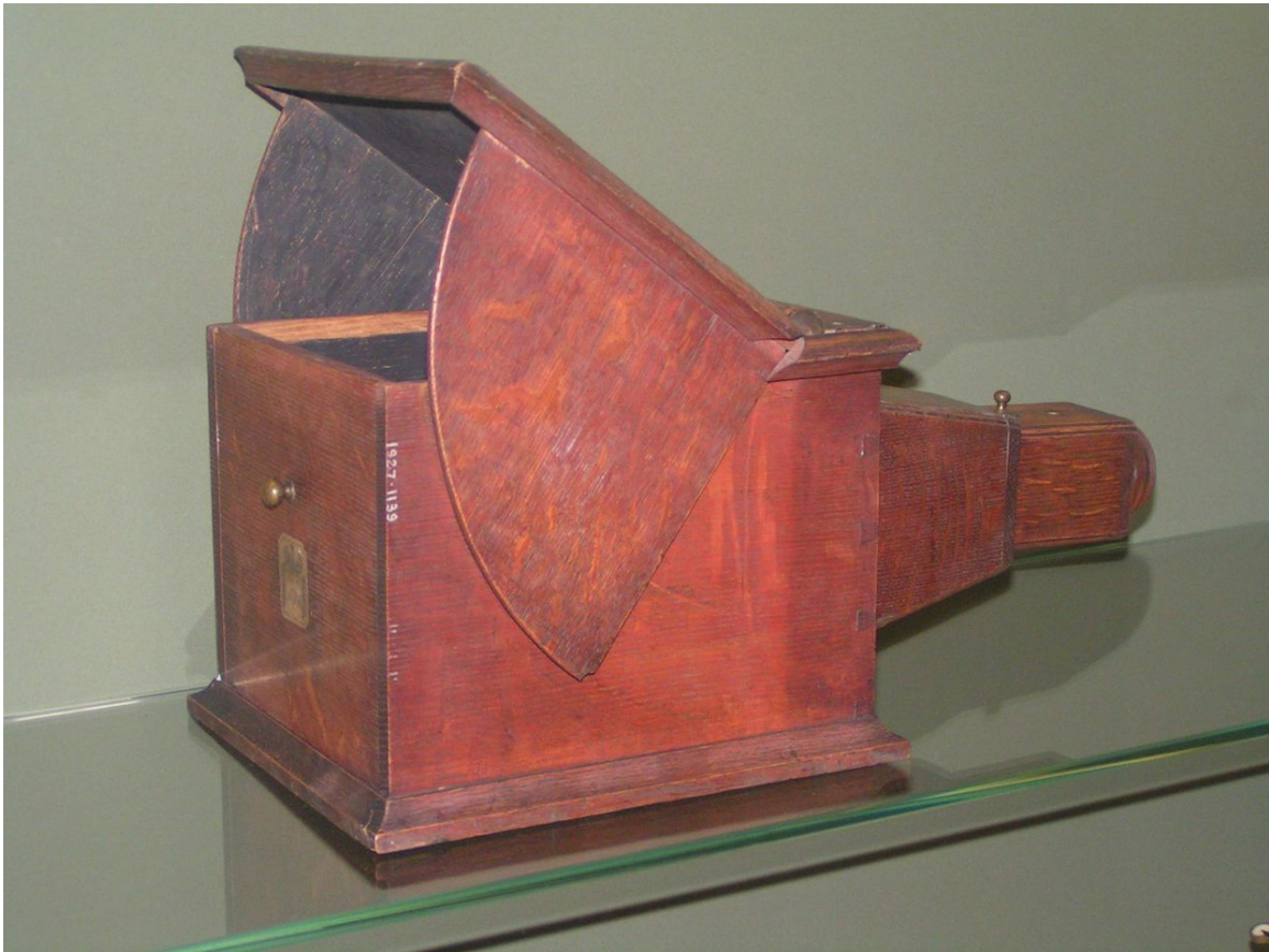
Abb. 24 Eine Camera obscura aus dem 18. Jahrhundert. Sie wurde vor allem zum Skizzieren von Bildern verwendet.
