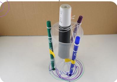
Nun kann der Zeichenroboter getestet werden. Schalte die elektrische Zahnbürste ein. Durch die Vibration der Zahnbürste und der Berührung mit dem Becher wird dieser in Bewegung gesetzt.
