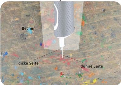
Die Motorachse berührt den Becher und überträgt so die Vibration. Die dicke Seite des Zahnbürstenhandstücks muss am Becher aufliegen.
