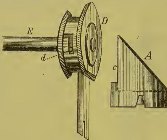
Ferner ist der Tubusansatz zur Aufnahme des Tubus, ganz aus Metall gefertigt, derart angepasst, dass er fest an die Prismafäche *c* anschliesst. Dementsprechend fügt sich auch die Augenöffnung des Tubus, an der der weite Trichter beseitigt wurde, gleich mit dem allgemeinen Tubuslumen unmittelbar fest an die Prismafäche *c* an; ausserdem ist das Tubusansatzstück *D* mittelst Bajonnettverschluss *d* mit dem Tubus *E* verbunden.
