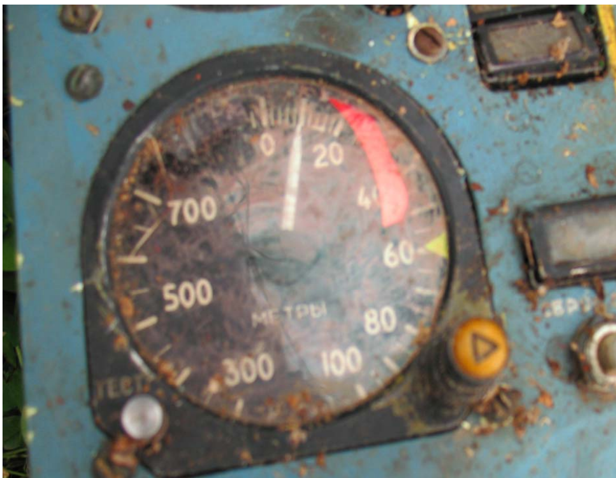
Рис. № 10. Индикатор радиовысотомера.
