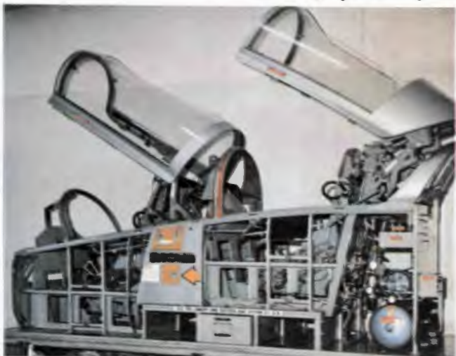
بالا: دستگاه کمک آموزشی مربوط به سیستم هیدرولیکی چرخ جت. پایین: دستگاه کمک آموزشی سیستم رها ساز صندلیهای پرتاب شونده جت دو کابینه.
