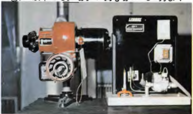
بالا : از وسائل کمک آموزشی مربوط به سیستم سوخت جت - پائین از وسائل کمک آموزشی مربوط به موتور احتراق سیستم تهویه مطبوع
