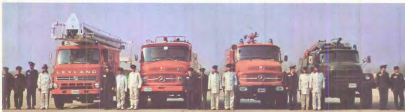
نمونه‌هایی از خودروهای آتش نشانی یگانهای نیروی هوایی شاهنشاهی از چپ بر راست: خودرو آتش نشانی و نجات حامل نردبان هیدرولیکی - بنز آبکش کف ساز - بنز پودری ۴۰۰۰ کیلوئی - خودرو آتش نشانی کف ساز.
