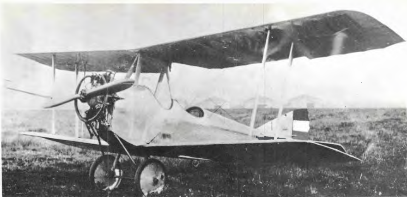
" پوتز - ۸ " هواپیمای آموزشی مقدماتی دو باله و دو فرمانه ساخت فرانسه که در سال ۱۳۰۳ وارد خدمت هواپیمایی نظامی ایران گردید . این هواپیما مجهز به یک موتور آنزانی دارای ۴۵ اسب قدرت - حداکثر سرعتش ۸۸ میل در ساعت - حداکثر وزنش هنگام برخاستن ۱۲۴۹ پوند و سرعت اوجگیری اولیاش ۴۴۳ پا در دقیقه بود ( در پائین صفحه طرح سه جانبه " پوتز - ۸ " مشاهده میشود ) .
