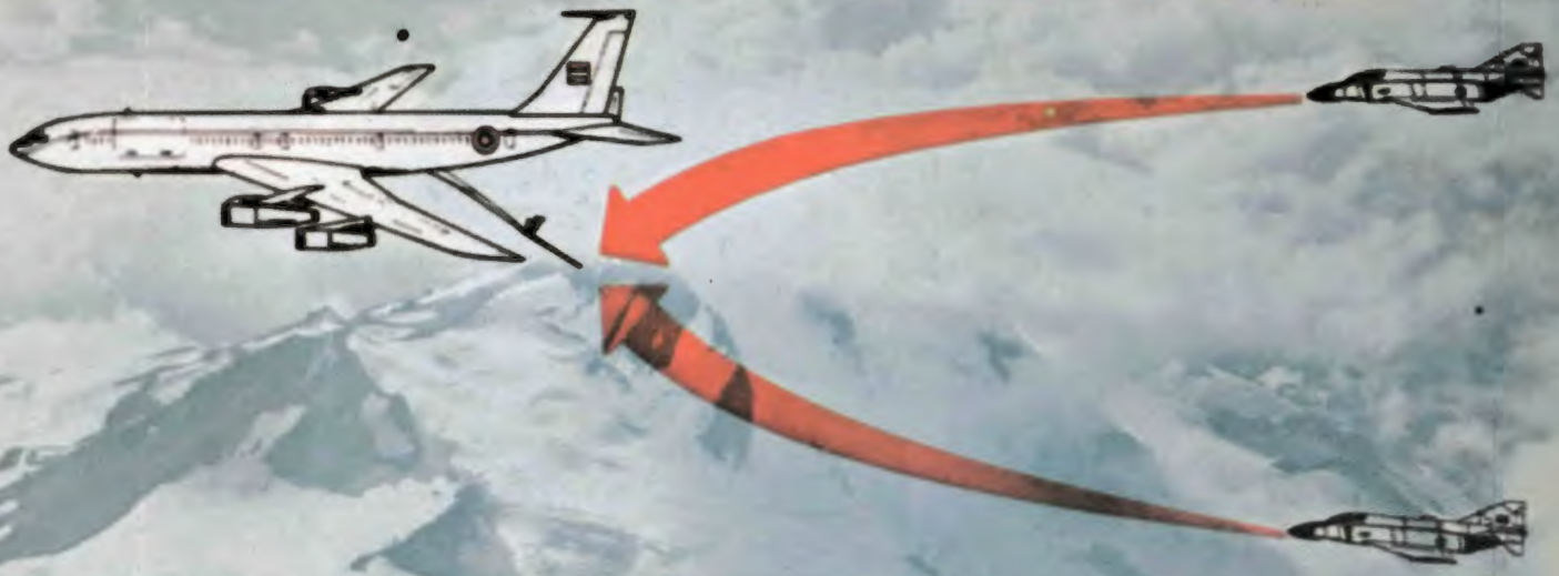
عکس بالا هنگام تقرب دو فروند هواپیمای فانتوم را برای سوختگیری حین پرواز از یک فروند هواپیمای تانکر " کی - شی - ۷۰۷ " نیروی هوایی شاهنشاهی مجسم نموده و عکس پائین انجام سوختگیری یکی از فانتومها را ( در حالیکه فانتوم دیگر منتظر نوبت میباشد ) مجسم کرده است .
