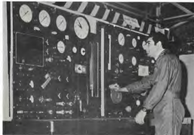
از متخصصین یکی از یگانهای نیرو در حال بازرسی سیستم هیدرولیک یک هواپیمای شکاری بوسله؛ دستگاه آزمایش سیستمهای هیدرولیک
