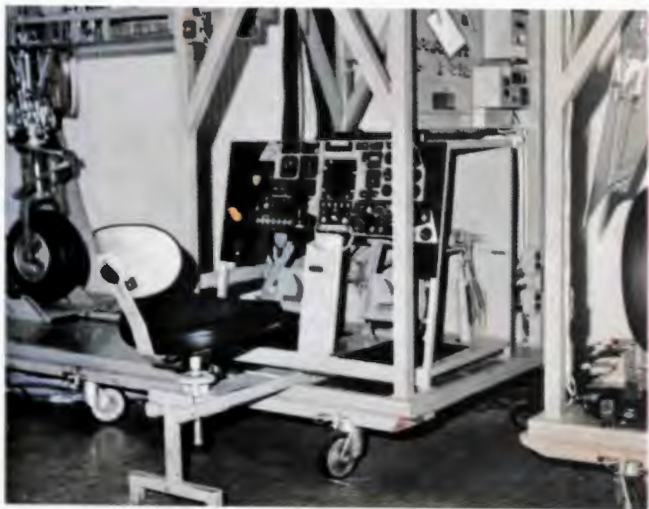
بالا: دستگاه کمک آموزشی مربوط به سیستم هیدرولیکی چرخ جت. پایین: دستگاه کمک آموزشی سیستم رها ساز صندلیهای پرتاب شونده جت دو کابینه.
