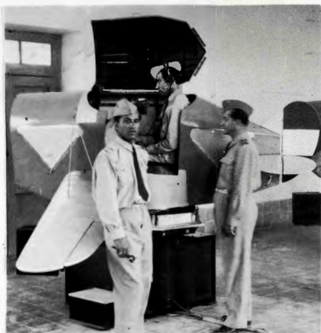
اولین دستگاه "لینکترینر" که برای آموزش پرواز کور (بدون دید خارج) در آموزشگاه خلبانی نیروی هوائی شاهنشاهی مورد استفاده قرار میگرفت - در جلو دستگاه (از چپ بر راست) سرگرد طوفانیان (ارتشبد کنونی) و سرهنگ طرفه (سرتیپ بازنشسته) و داخل کابین دستگاه یکی از دانشجویان دانشکده خلبانی دیده میشوند.
