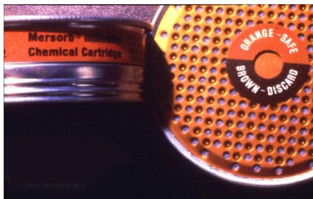
Пассивный индикатор противогазного фильтра, предназначенного для защиты от ртути. При насыщении сорбента меняет цвет с оранжевого на коричневый. Этот рисунок добавлен к переводу, отсутствует в оригинале.
