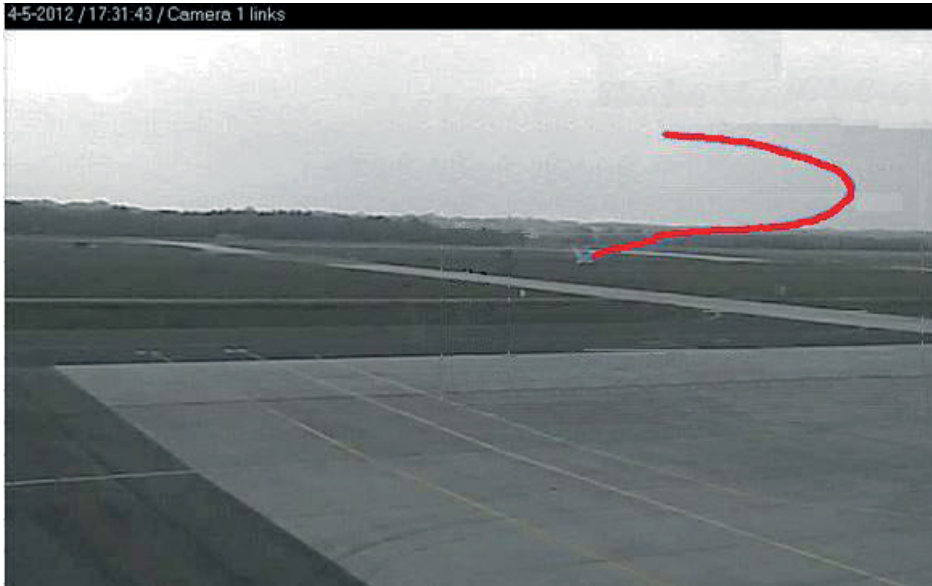
Figuur 5: Opname beveiligingscamera met daarin het toestel net voor het moment van impact en het gereconstrueerde vliegpad (rood).
