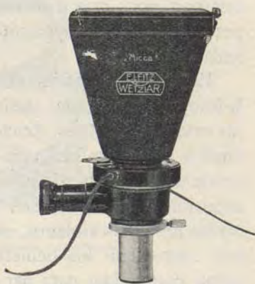
Fig. 43. — Camarita para colocar en lugar del ocular de Leitz.
