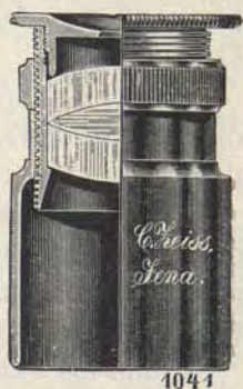
Fig. 45. — Lente para examinar la imagen en el cristal deslustrado.
