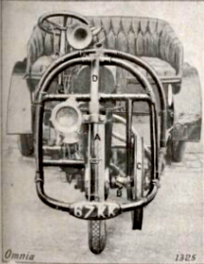
Fig. 2. — TRI-VOITURETTE " ORUS " VUE PAR L'AVANT ET DE CÔTÉ. — A, roue directrice et motrice. — B, joint de cardan. — C, poulie à gorge conique réceptrice. — B', la courroie. — D, bâti en tube. — E, fourche de direction. — F, embrayage. — G, ventilateur du moteur (à 2 cylindres). — H, réservoir à essence et huile.
