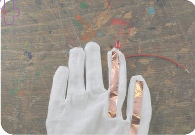
Der Minuspol der LED (das kürzere Bein) wird auf das Kupferklebeband gelegt und mit einem Isolierband angeklebt.
