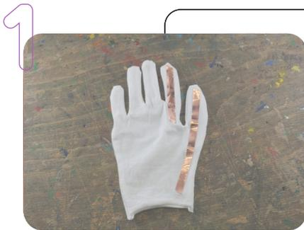
Zuerst werden die Kupferklebestreifen auf die Länge des Zeigefingers und des Daumens zugeschnitten und angeklebt. Ein wenig leichter geht es mit dem Mittelfinger. Je breiter der Streifen, desto besser funktioniert anschließend der Schaltmechanismus.
