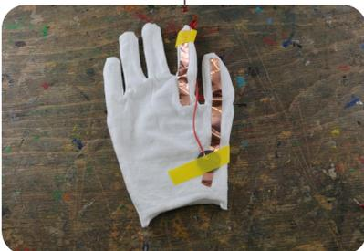
Die Batterie wird mit der Minusseite nach unten auf das Kupferklebeband des Daumens gelegt, das Litzenkabelende auf die Plusseite, und beide mit einem Isolierband festgeklebt.
