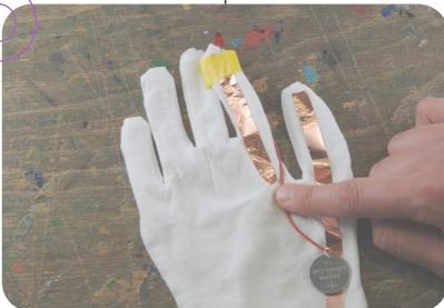
Nun wird das Litzenkabel, das mit der LED verbunden ist, mit dem Pluspol der Knopf-batterie verbunden.
