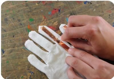
Sollten beim Kupferklebeband zwei Streifen übereinander geklebt werden, muss beachtet werden, dass die Klebeseiten nicht leiten!
