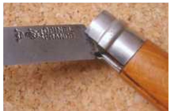
Das gleiche Messer mit gelöstem Sicherungsring - die Klinge kann eingeklappt werden
