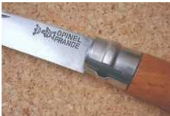
Die Klinge ist mittels gedrehtem Sicherungsring fixiert
