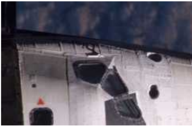
Beschädigte Stelle der Shuttle-Isoliermatte
