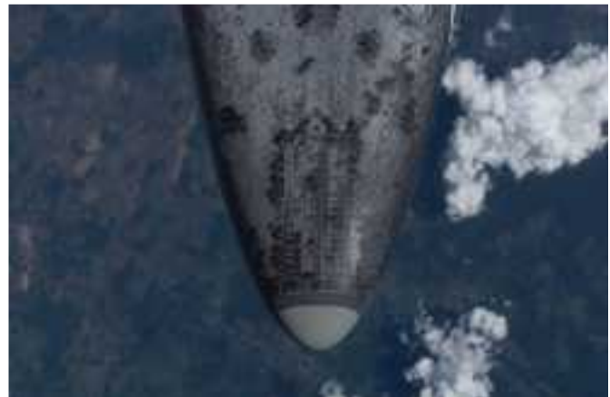
Fotografie der Hitzekacheln, Bug-Unterseite der Discovery
