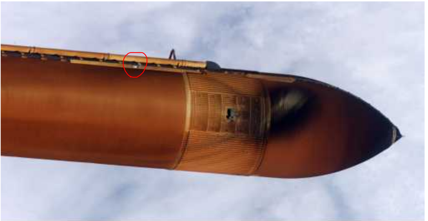
Der Treibstofftank fällt zurück zur Erde. Rot umrandet ist die Stelle an der ein Stück abbrach.
