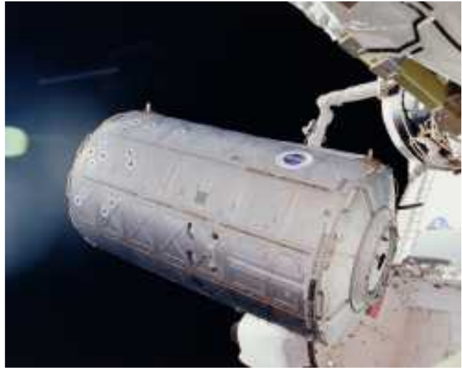
Destiny Modul bei der Installation
