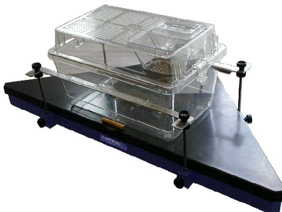
Вибрации, вызываемые движением животного собираются углеродно – волокнистой измерительной пластиной и передаются к датчикам силы, которые находятся внизу пластины. Преобразователи силы соединены с двойным низко-шумовым предусилителем и прибором формирования сигнала, которая установлена в платформе измерения.
