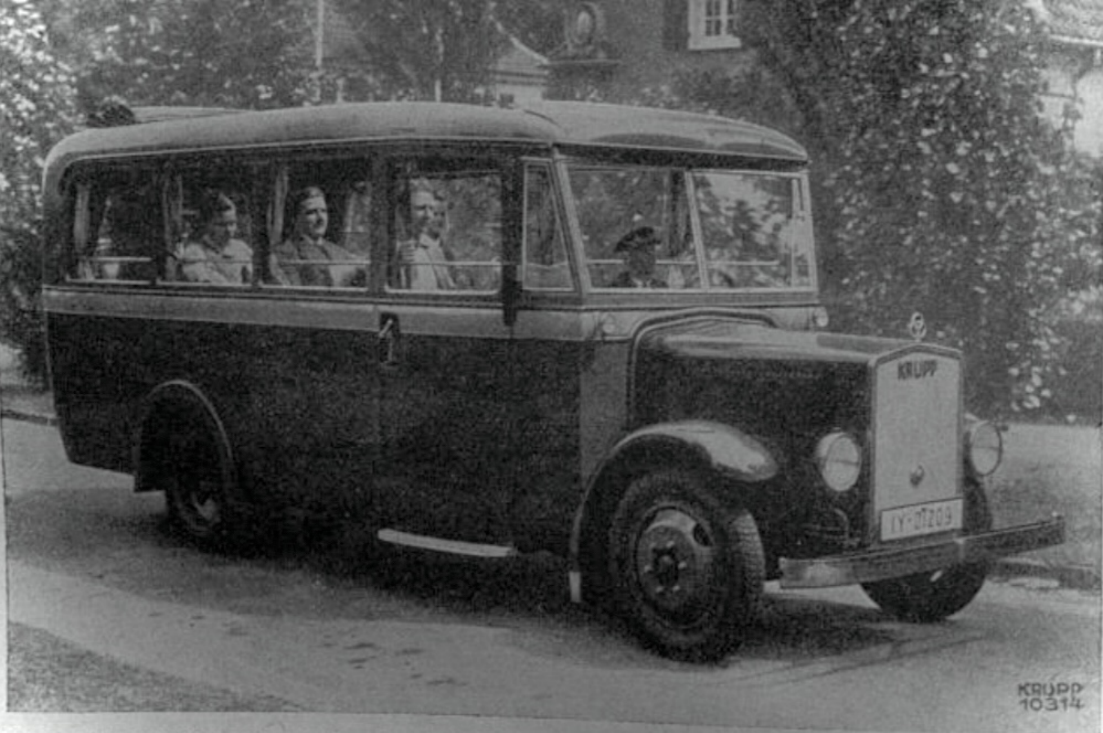
Sogar für Omnibusse werden heute luftgekühlte Motoren verwendet! Krupp-Allwetter-Omnibus für 24 Fahrgäste mit luftgekühltem 60-PS-Krupp-Vergaser- motor
