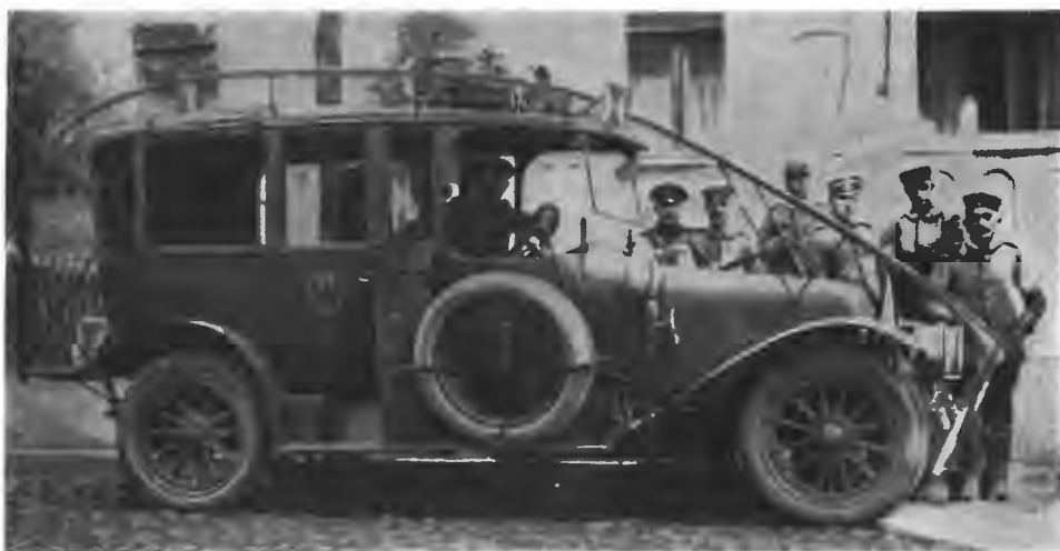
Автомобиль императора Вильгельма, снабженный спереди особымъ приспособленіемъ для разрыванія проволоки, протягиваемой поперекъ дороги.
