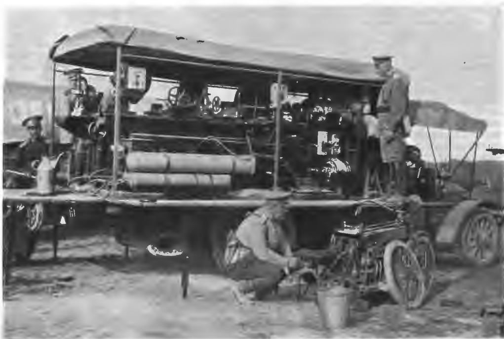
Автомобильная мастерская для ремонта автомобилей и мотоциклов. По фот. нашего специального корреспондента.
