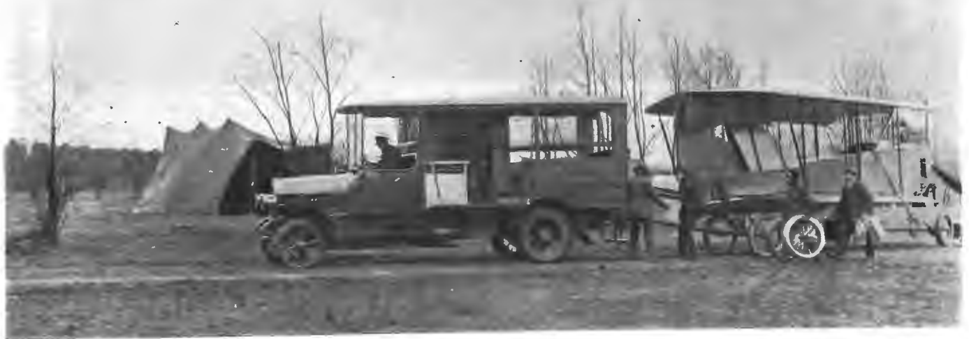
Германскій автомобиль-мастерская, везущій платформу съ аэропланомъ. Захваченъ нашими войсками подъ крѣпостью Ивангородомъ.
