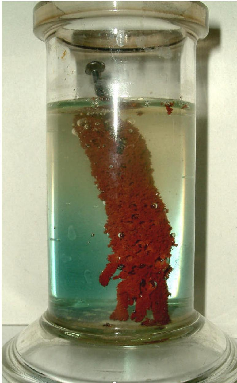
Abb. 160 Eisennagel in Kupfer(II)-Sulfatlösung
