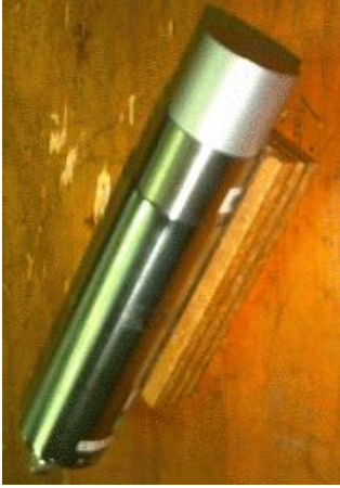
Abb. 42 Ein NaI Kristall, der mit einem Photomultiplier verbunden ist.
