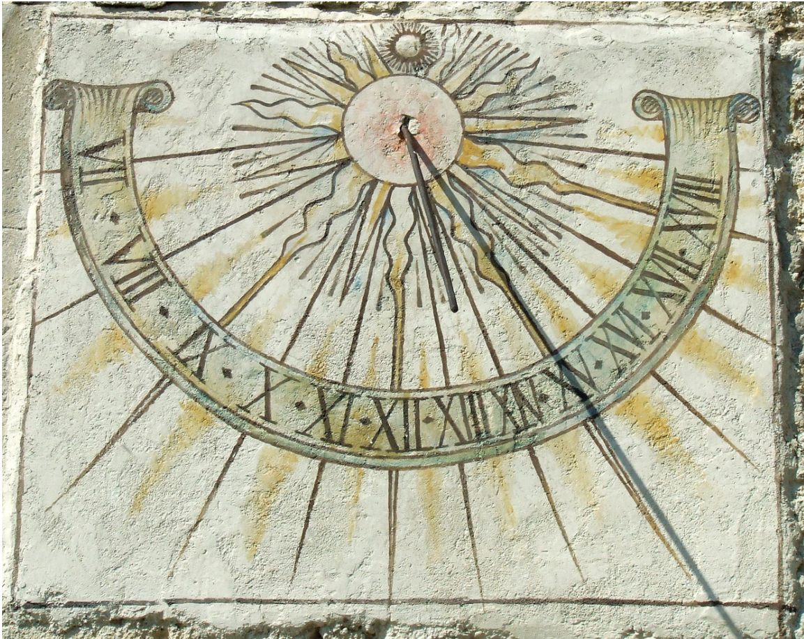
Abb. 6: Beispiel einer einfachen Sonnenuhr mit geradem Gnomon und geraden Stundenlinien auf dem Zifferblatt
