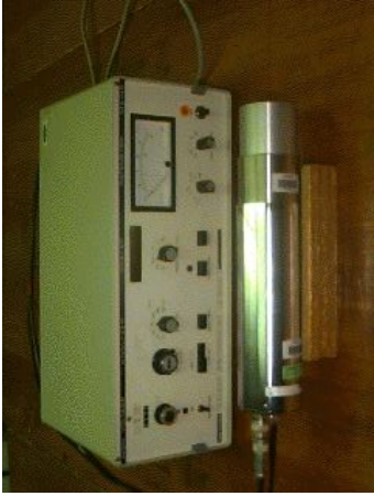
Abb. 45 Ein Einkanalanalysator mit einem Kristall-Photomultiplier-Aufbau.
