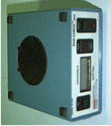
Abb. 35 Ein Dosimeter wie es in der Radiographie verwendet wird.
