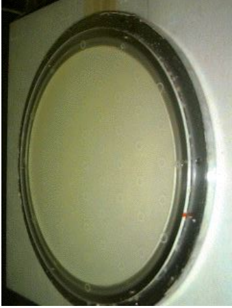
Abb. 55 Der NaI Kristall einer Gammakamera.
