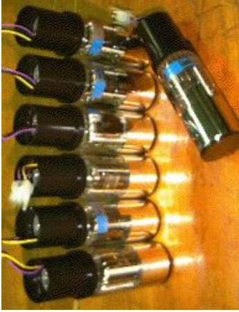
Abb. 43 Einige identische Photomultierröhren von einer Gammakamera.
