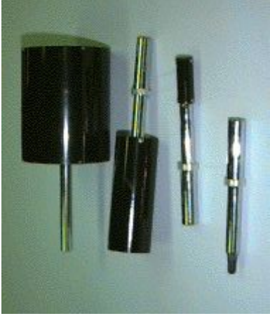
Abb. 32 Einige Ionisationskammern mit unterschiedlichem Volumen zur Messung der Ionendosis.
