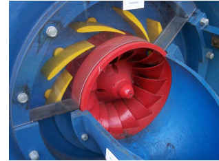
Abbildung 17: Leitwerk einer Francis-Turbine für maximale Leistung eingestellt
