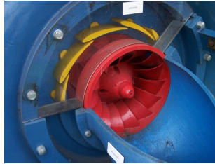
Abbildung 16: Leitwerk einer Francis-Turbine für minimale Leistung eingestellt
