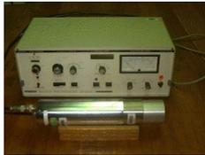
Abbildung 46: Ein Einkanalanalysator mit einem Kristall-Photomultiplier-Aufbau.
