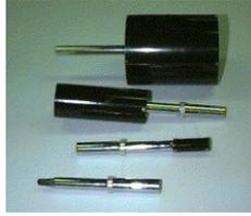
Abbildung 33: Einige Ionisationskammern mit unterschiedlichem Volumen zur Messung der Ionendosis.
