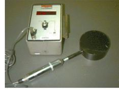
Abbildung 34: Ein Dosimeter wie es in der Radiographie verwendet wird.
