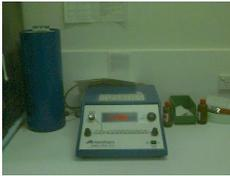
Abbildung 35: Ein in der Nuklearmedizin verwendeter Dosiskalibrator - der blaue Zylinder links enthält die reentrante Kammer
