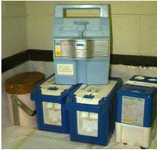
Abbildung 96: Fünf 99m-Tc Generatoren.
