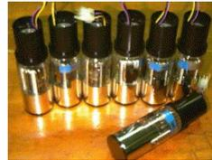
Abb. 44: Einige identische Photomultiplerröhren von einer Gammakamera.
