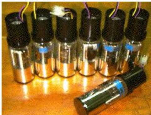
**Abb. 43** Einige identische Photomultiplier-Röhren von einer Gammakamera.
