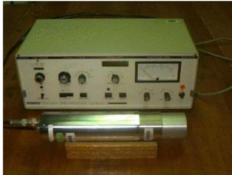
**Abb. 45** Ein Einkanalanalysator mit einem Kristall-Photomultiplier-Aufbau.
