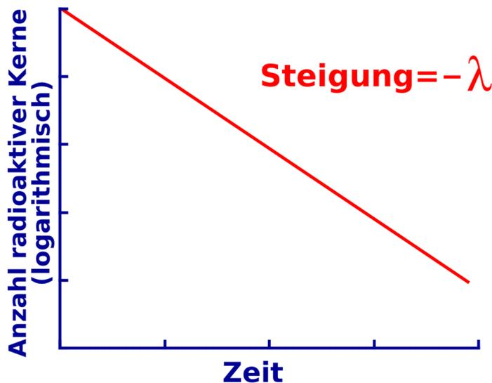
**Abb. 10** Exponentieller Zerfall von Kernen (logarithmische Darstellung)
