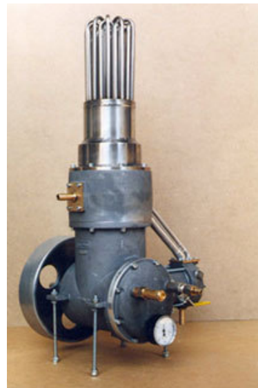
Abb. 19 ST05 (geänderter Erhitzerkopf)
