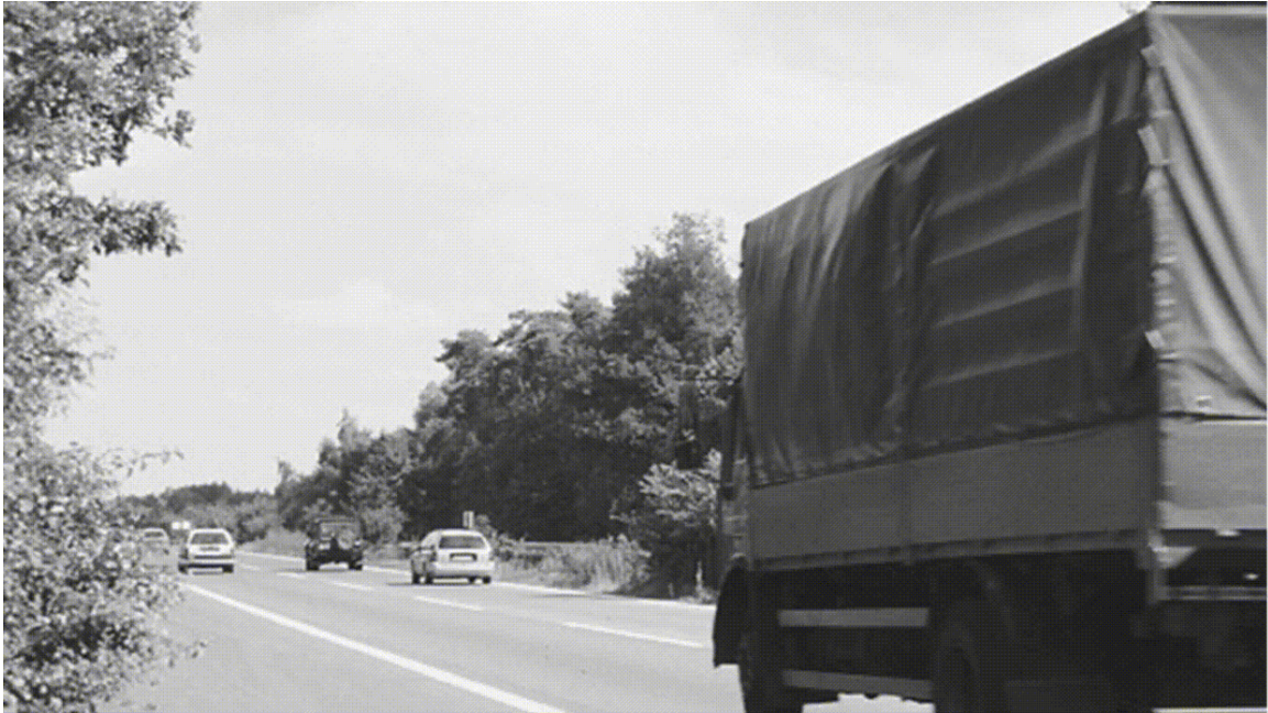
Abb. 16 Durch die Umströmung des fahrenden LKW wölbt sich die Plane hinter der Fahrerkabine nach außen
