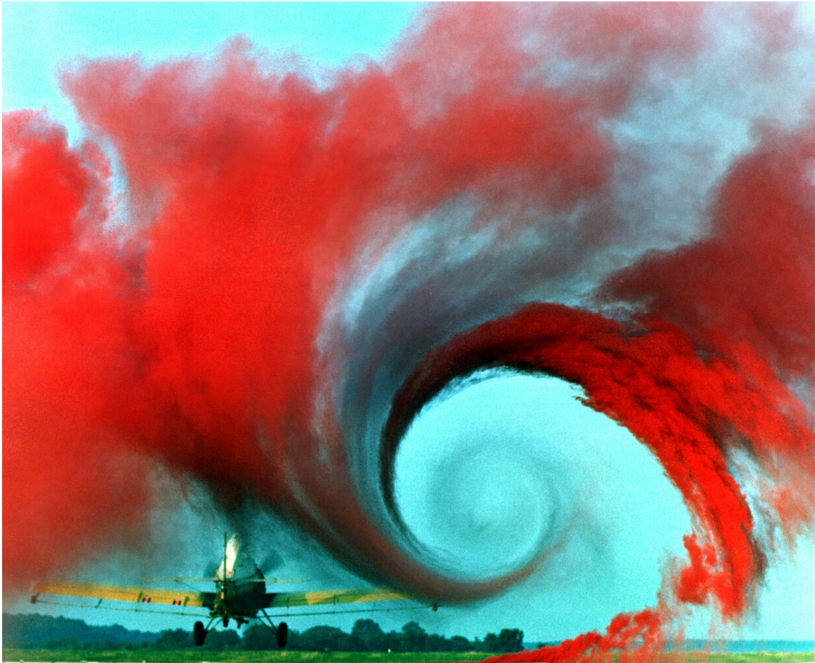
Abb. 44 Luftbewegung einer Rauchwand beim Durchfliegen
