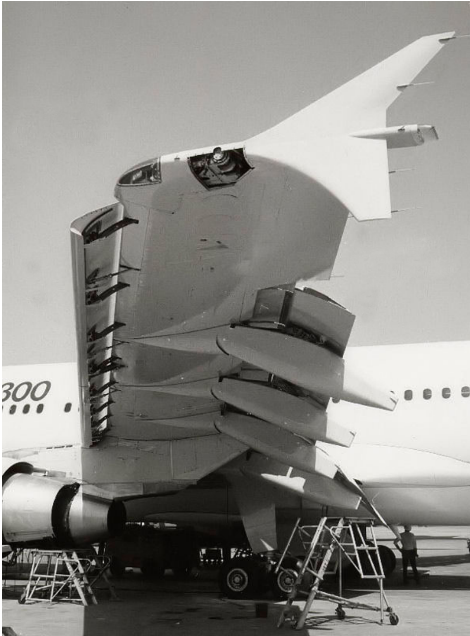
Abb. 27 Ausgefahrene Vorflügel und Landeklappen eines modernen Verkehrsflugzeuges
