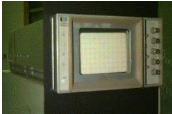
Abb. 56 Kathodenstrahlzilloskop einer Gammakamera.
