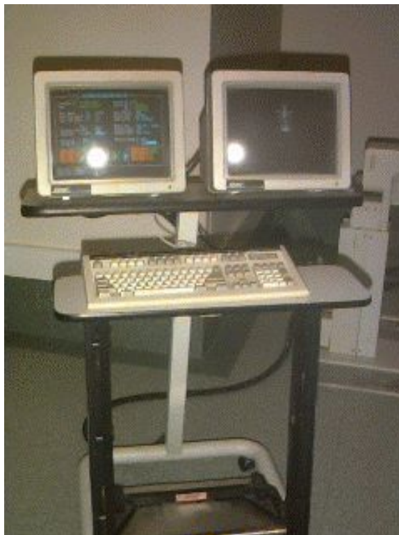
Abb. 60 Der Bildbearbeitungsarbeitsplatz einer Gammakamera mit zwei Köpfen.
