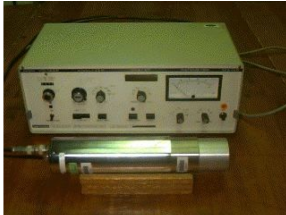
Abb. 45 Ein Einkanalanalysator mit einem Kristall-Photomultiplier-Aufbau.
