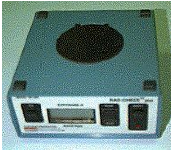
Abb. 35 Ein Dosimeter wie es in der Radiographie verwendet wird.
