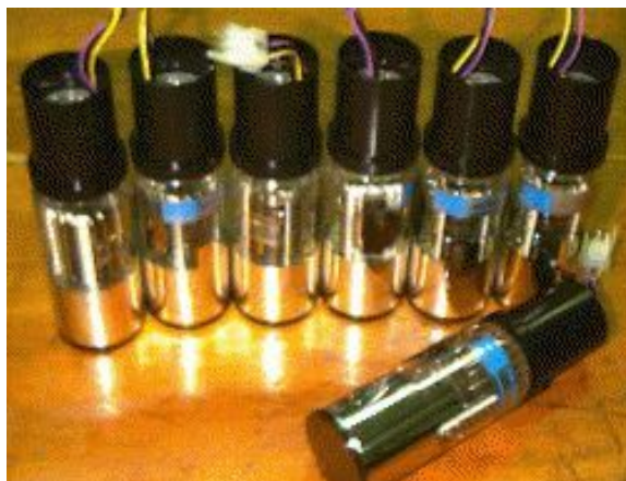
Abb. 43 Einige identische Photomultiplerröhren von einer Gammakamera.
