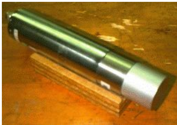
Abb. 42 Ein NaI Kristall, der mit einem Photomultiplier verbunden ist.
