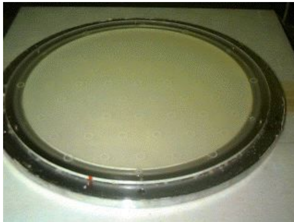
Abb. 55 Der NaI Kristall einer Gammakamera.
