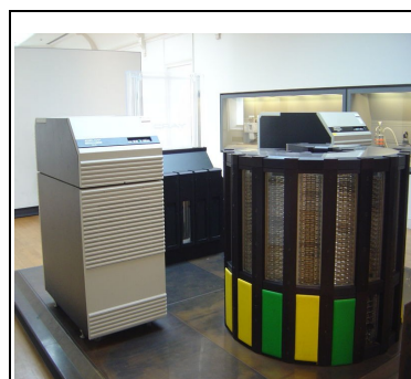
Il Cray-2. Dentro il cilindro si trovano le CPU e il liquido di raffreddamento. A lato gli hard disk
