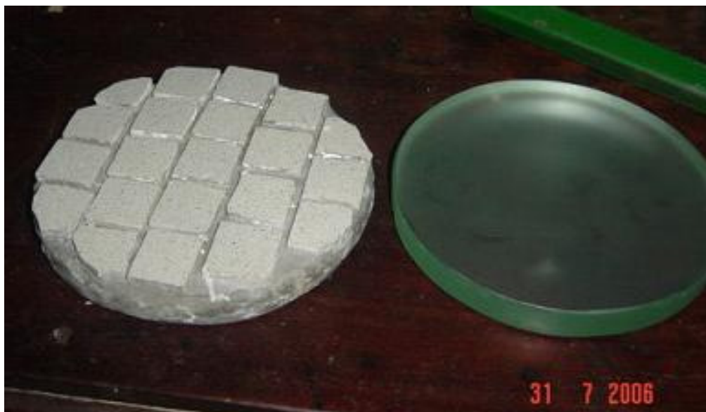
Hình . Đĩa mài đúc gạch,xi măng và gương 100mm đã qua mài tinh.
