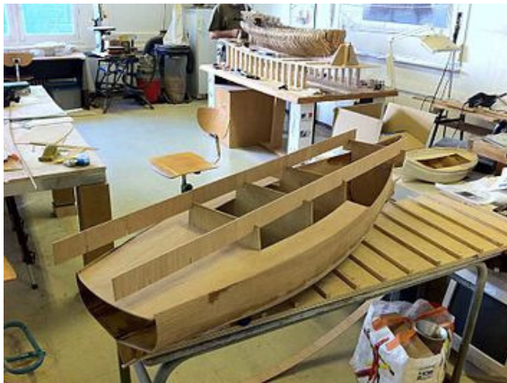
Positionnement des cloisons
