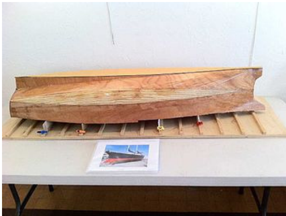
Technique de construction par plaques.
