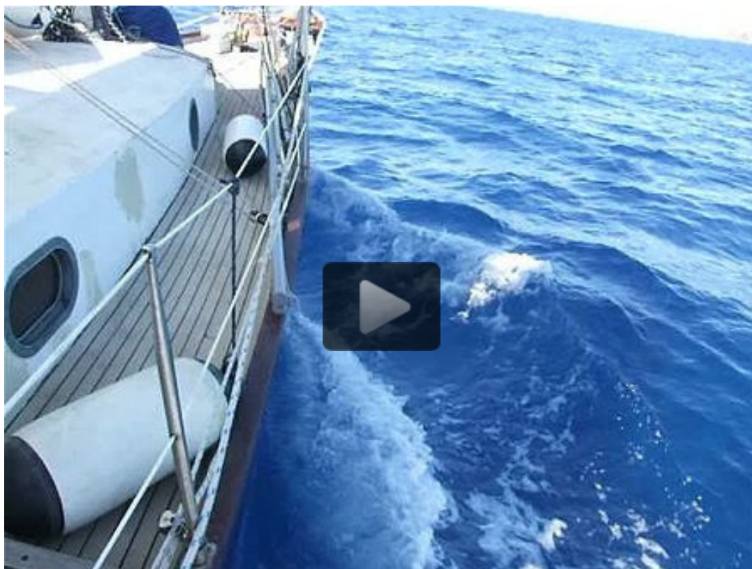
Cardabela Le bulbe casse la vague d'étrave à 7 nœuds.
