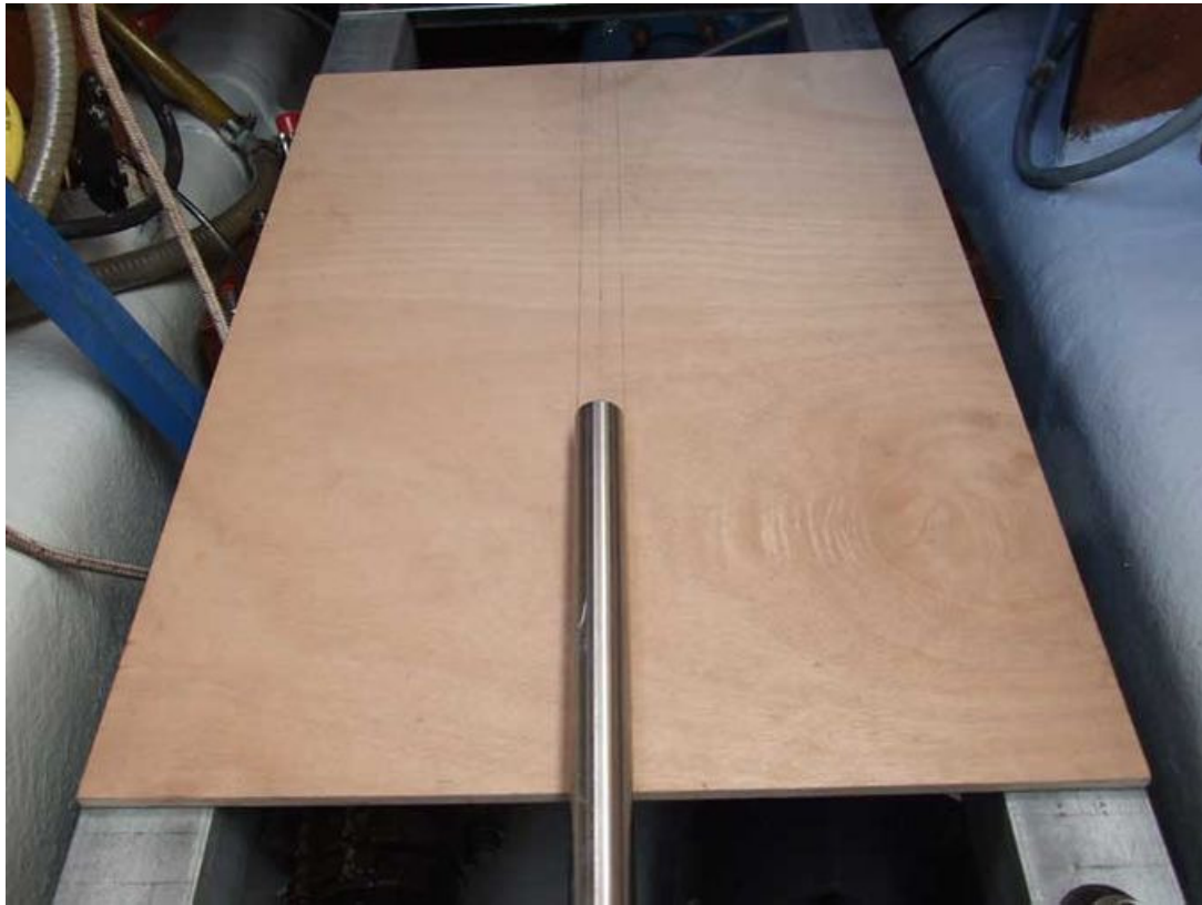
Alignement du support moteur
