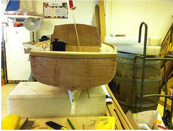
Pose du guide de safran tribord, vue de la poupe. L'inclinaison doit être perpendiculaire au plan de la coque
