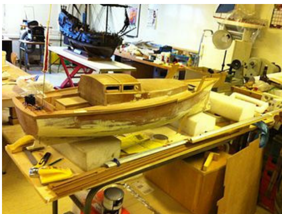
Pose du guide de safran tribord, avec vue du cockpit amovible
