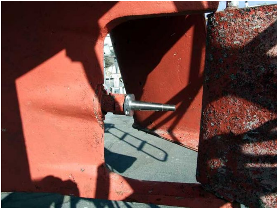
Positionnement précis de l'arbre d'hélice
