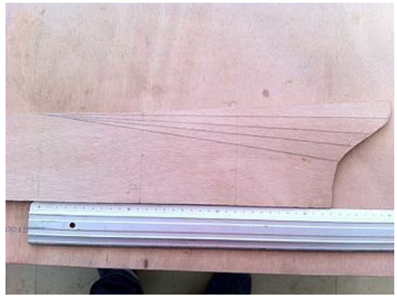
Vue des incisions intérieures pour le cintrage avant.
