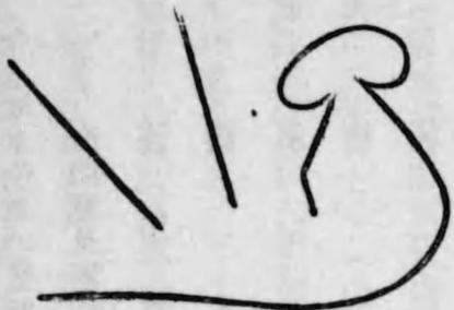
淺海漁柵の一種 上圖は小灣に於て建設するものにて垣は竹にして其長各二十五ワアー宛、其竹數二百二十五本、他は全部竹簧にして十個、其一個の巾は二ソツク魚溜は二個よりなり、一側は一個、他側は七個の簧よりなる縦木横木を用ふること深海漁柵に同じ、之れが建設海深は五、六ソツクにして其新設費十二銖、一期間八十銖乃至百銖の捕獲高あり。船は十一ソツク一人にて捕漁す。即ち最低潮海深二ソツク乃至一ソツク位の時出漁抄網を用ひて捕漁す。
