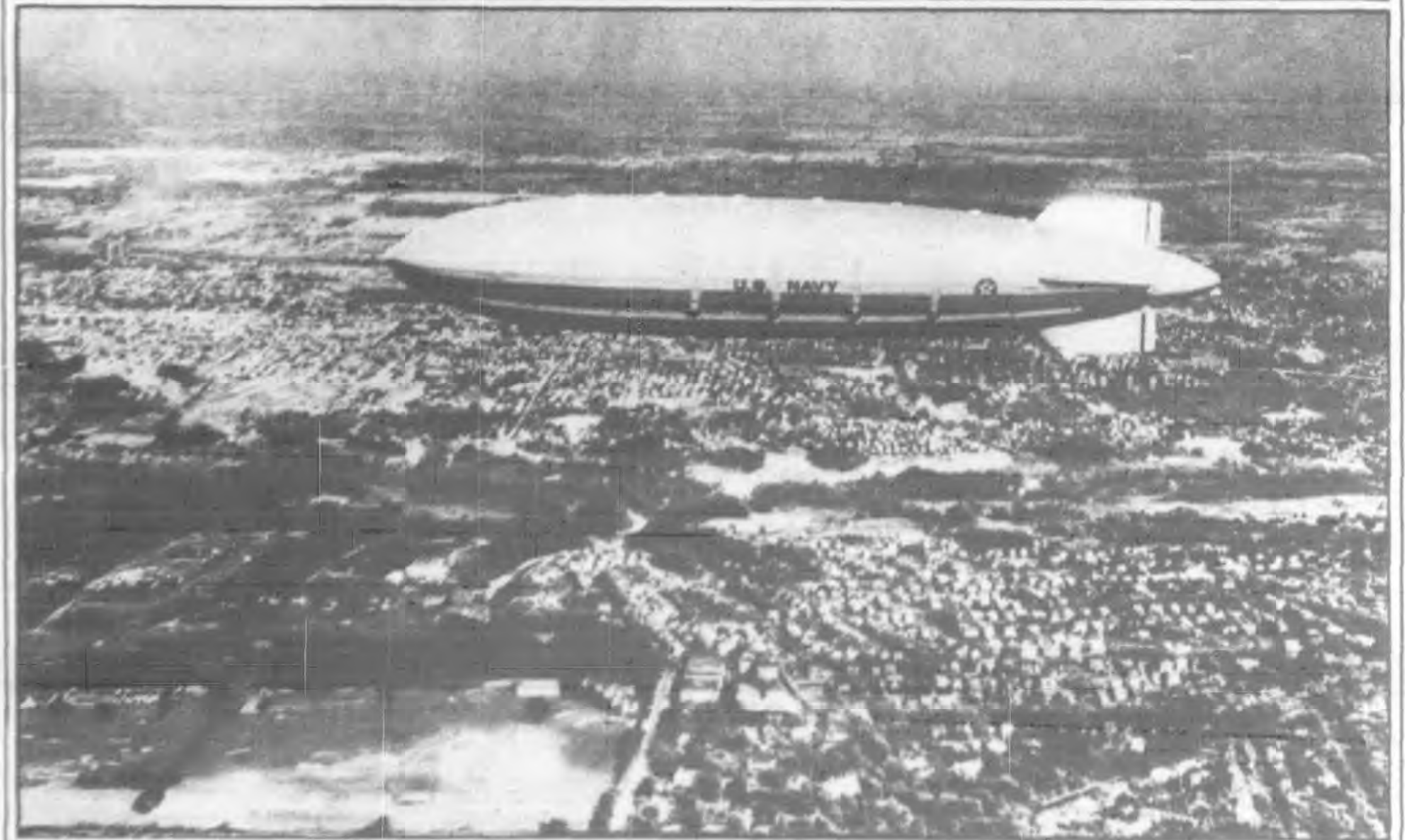
上二圖爲美國海軍之大飛船名『阿克龍』(Akron)長 785 英尺係用不能燃燒爆裂之氦氣 (Helium) 以行船爲現在世界上最大最新之飛船上爲其內部解剖之一部下爲其在俄亥俄 (Ohio) 東北部之處女航
