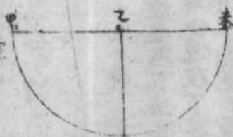
如子為下面一點甲乙為水面因水之各點俱定故自未至于諸點可當作一條線直交甲乙水面當水足時此線與四面之水一似不相聯屬四面之水一如定質但此線為流質而子點抵力僅為子未線上各點抵力所生各點向下之力必經過未子線加于子點數等點抵力為全線各點向下方之和即各點之全重故線愈長即水愈深抵力愈大也
