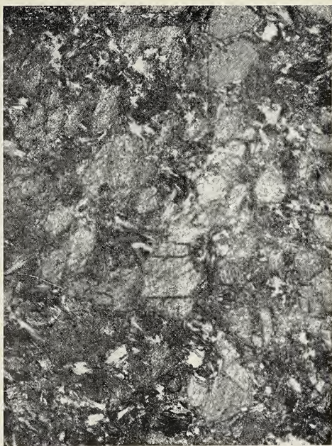
Fig. 2. — Calcite: grandi cristalli di neoformazione, con piccole masse di idromagnesite. (Nicols X; Ingrandimento: \times 50 ).
