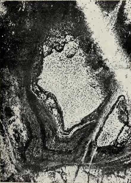
Fig. 3. - Cristallo di periclasia con prodotti ferruginosi di alterazione a struttura concrezionata.
