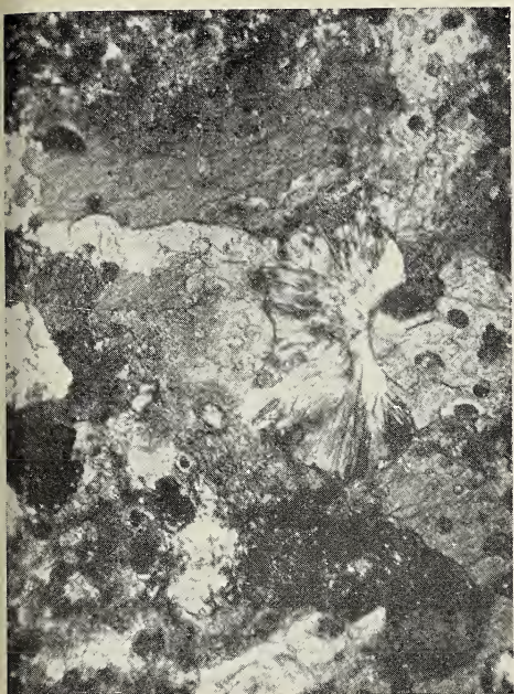
Fig. 1. — Idromagnesite a struttura fibroso-raggiata, con cristalli di calcite e granuli di dolomite residua. (Nicols X; Ingrandimento: \times 50 ).
