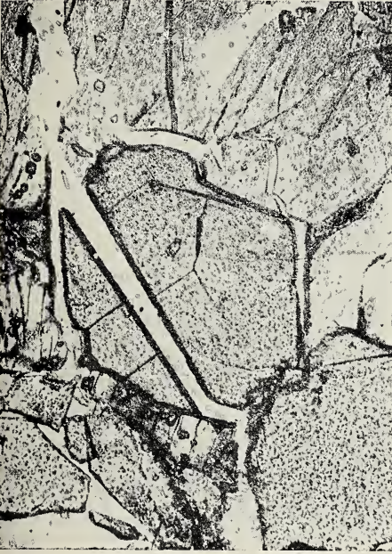
Fig. 1. - Periclasia. Abito ottaedrico con tracce di sfaldatura. Nicols //; ingrandimento: \times 50 .
