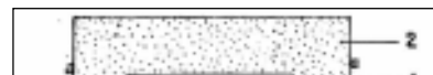
ಚಿತ್ರ 3. ಚಿತ್ರದಲ್ಲಿ 1. ಮಾದರಿಯ ಕೆಳ ಅರ್ಧ, 2. ಕೆಳಗಿನ ಪೆಟ್ಟಿಗೆ, 3. ಮೇಲಿನ ಪೆಟ್ಟಿಗೆ, 4. ಮಾದರಿಯ ಕೊಂಬು ಇದ್ದ ಸ್ಥಳ, 5. ತೆರಪಚ್ಚು
