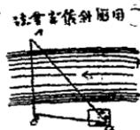
水深及河底性質。爲決定橋脚種類必要之件。測定水深。在橋軸綫上引伸長繩。（預先標示若干點或各橋脚點位置）再撐小舟徐徐沿繩而潛行。再用刻尺度之竹竿。逐次測量各點之水深。同時須探知河底性質。因與設置架柱植樁錨定等有關係故也。又依附近地勢。亦概得推知河底性質。即在山地或其附近之河川。河底係岩石質或石礫。其流於平野者。則砂礫或細砂。接近河口之部分則常爲泥砂。
