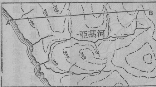
第七十八圖 圖中有在一百尺垂直間隔之等高線之圖 注意等高線如何由 V'S 而上至山谷之情形
