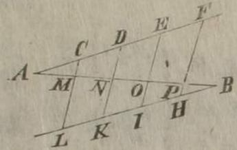
答 線の一端  $A$  より  $F$  を隨意の斜線 但し  $\angle FAB$  角を九十度以下にする を画き又他の一端  $B$  より  $AF$  を平行して  $BL$  線を画き而して  $A$  より 其距離より  $C$  点を定め  $CD$   $DE$   $EF$  を同距離より定め更に  $B$  より  $AC$   $CD$  等と同距離より  $BH$   $HI$   $IK$   $KL$  を定め後  $CL$   $DK$   $EI$   $FH$  を接する  $AB$  線内  $M$   $N$   $O$   $P$  於て會はぶ此會点即
