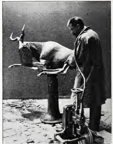
Abb. 7: Fräsmaschine mit biegsamer Welle und regulierbarer Geschwindigkeit, in ihrer Anwendung zum Modellieren von Holzkörpern.<sup>11)</sup>
