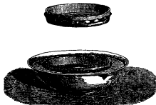
Діализаторъ. Приборъ для отдѣленія тѣлъ, просачивающихся черезъ перепонку, отъ тѣлъ непрочисающихся. Описание въ текстѣ.
