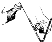
Испытаніе съ помощью тлѣющей лучины кислорода, полученнаго при разложеніи воды гальваническимъ токомъ. 1/2.
