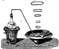
Приготовление воспламеняющегося на воздухе фосфористого водорода действием щелочи на фосфор.
