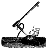
Рис. 2. Нагрѣваніе на углѣ съ помощью весьма удобной газовой паяльной трубки, въ которую газъ доставляется трубою ab, а воздухъ чрезъ с. \frac{1}{2} ю.
