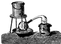
Рис. В.—Перегонка въ изогнутой ретортѣ, горло которой вставлено прямо въ приемникъ, охлаждаемый струей воды,—при нагреваніи на угольной жаровнѣ.
