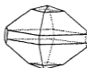
Ромбической системы, комбинація приемы, вертикальнаго пинакоида и двухъ пирамидъ: главнаго (большаго пинакоида) и таковой, у которой вертикальная ось = \frac{1}{2} оси первой пирамиды. Форма безводнаго стримонадроваго соли. Углы пирамиды въ горна. ребръ 122° 43'.
