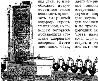
Приборъ для заводскаго сгущенія хлористаго водорода, выдѣляющагося въ печи. По трубкамъ ВВ, чрезъ конусовую башню, чрезъ М и N въ дымовую трубу втягивается изъ печи газъ въ смѣсъ съ воздухомъ, а еху на встрѣчу изъ Е, чрезъ башню, въ И и И идетъ вода, растворяющая хлористый водородъ. 1/10.
