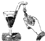
Разложеніе закиси азота металлическимъ натріемъ.
