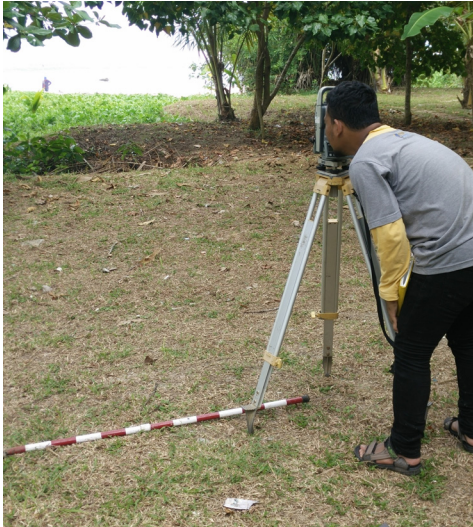
Gambar 3. Foto Pengukuran dengan Theodolith Total Station
