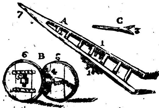
La figura A è la scala del carro Sardo, così stesso chiamata in Sardegna; il num. 1. la parte inferiore della scala, in cui di qua, e di là si colloca l'asse; la figura B l'asse colle ruote.
