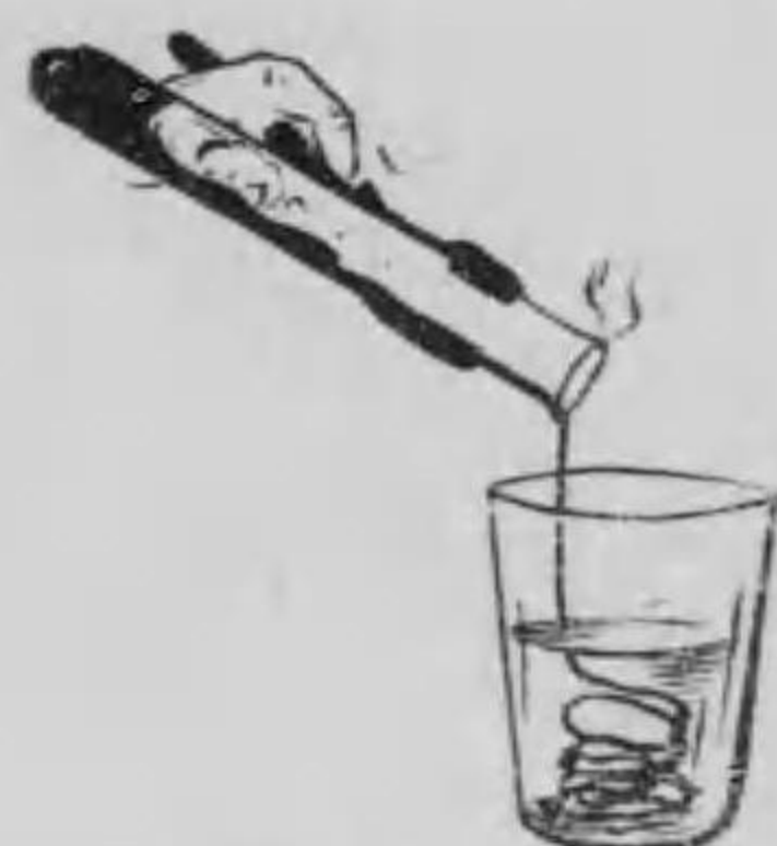
第六十七圖 ゴム狀硫黄 を製する有 様を示す
