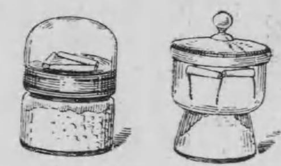
第七十三圖 硫酸を用ふる乾燥器を示す
