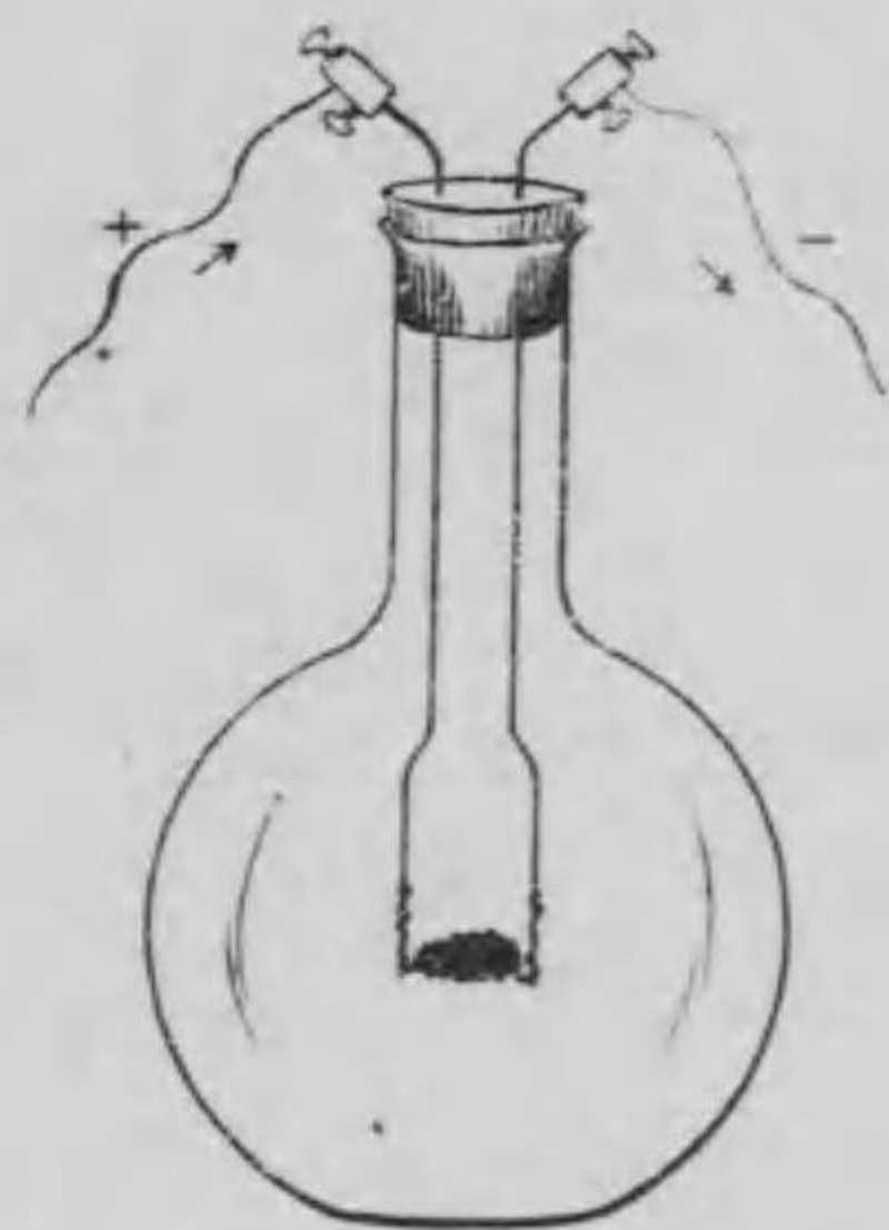
第十四圖 密閉器に於て木炭を燃焼せしめ其重量の變化せざるを示す
