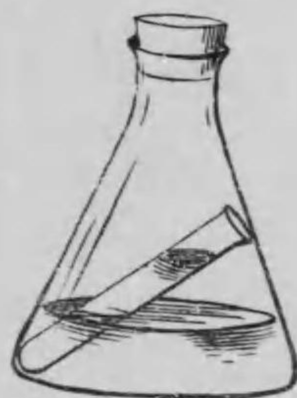
第十五圖 化學變化の前後に於て重量の不變を示す
