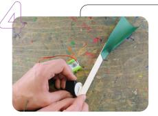
Nun wird das Katapult mittels doppelseitigem Klebeband an dem o11 servo Bit befestigt. Dabei ist die Ausgangsposition des servo Bits wichtig.
