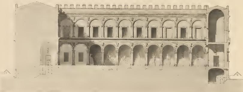
Querschnitt durch den Palazzetto mit Aufriß der südlichen Arkaden.
