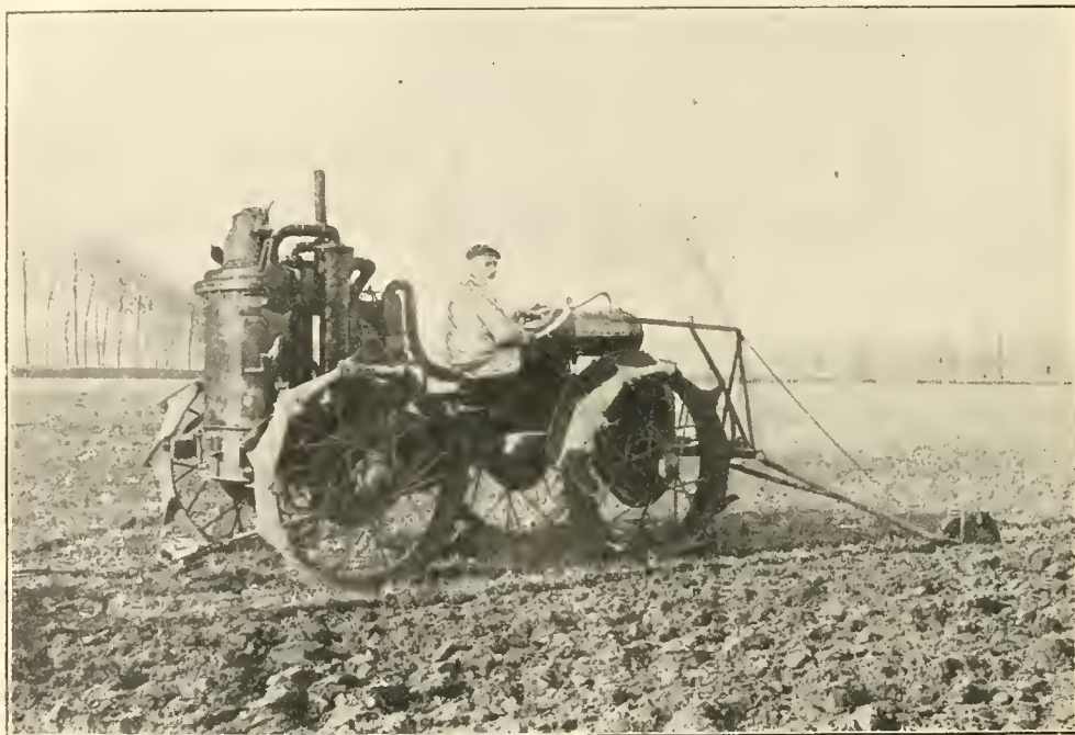
Fig. 32. — Gazogène Cazes, monté sur tracteur Pavési.
