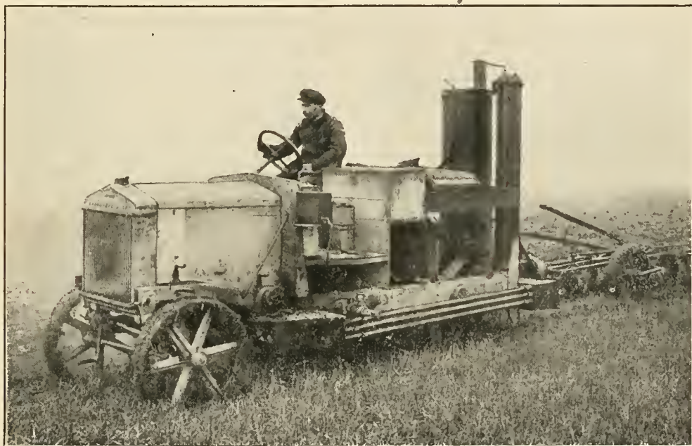
Fig. 33. — Gazogène de la Société française de matériel agricole de Vierzon, monté sur tracteur Tourand-Latit.
