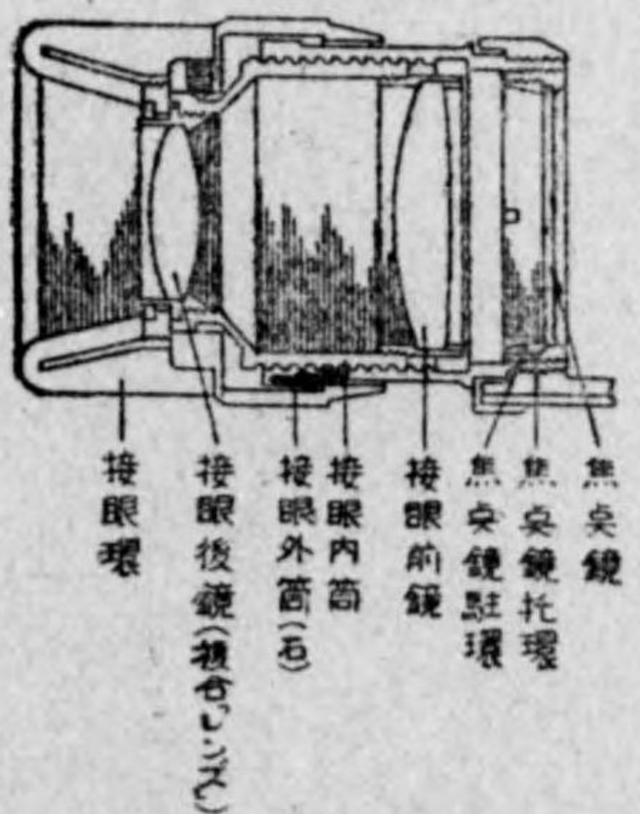
八九式雙眼鏡右接眼部構造圖 G H
