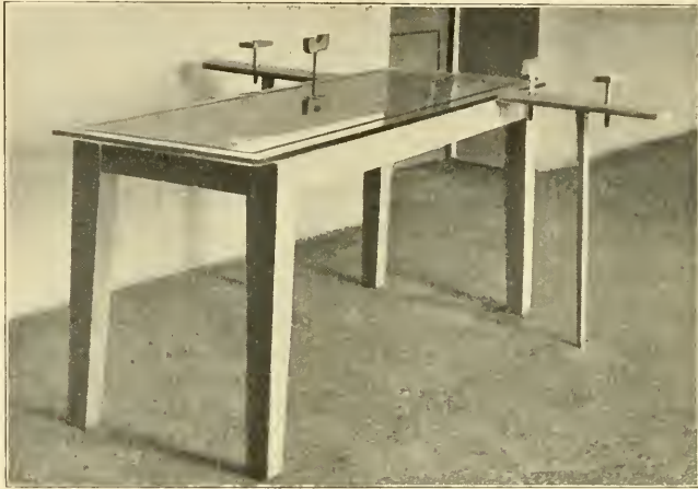
Fig. 1. Präpariertisch mit Platte aus Glas und Armhaltern. Photographie.
