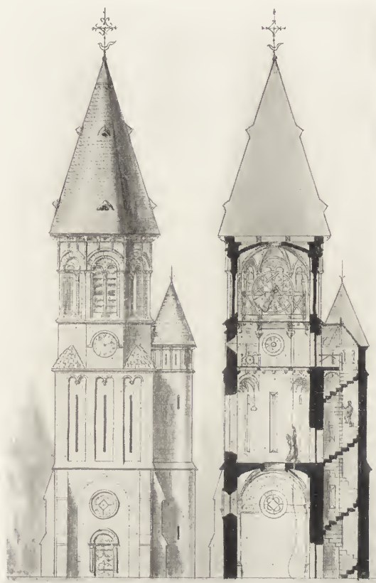
CLOCHER ISOLÉ, D'APRÈS LES PRE- SCRIPTIONS DE S. CH. BORROMÉE, PAR A. VAN GRAMBEREN.
