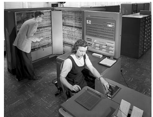
Fig. 2.1. Photo prise en mars 1957 au Centre de recherche Langley sur laquelle apparaissent une femme et un homme actifs sur une machine de traitement électronique de données IBM type 704 utilisée dans la recherche aéronautique (Source : https://w.wiki/377h ).
