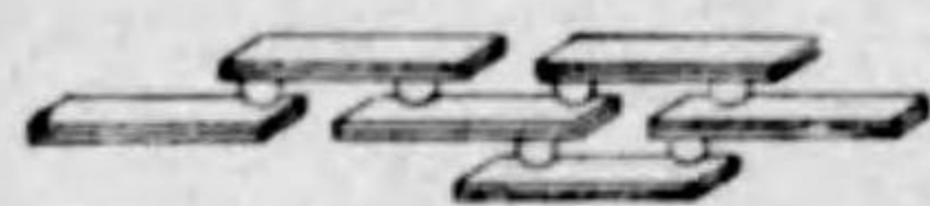
第 79 圖 (Hauser 原圖) 耐水性アルシフィルムの構造想像模型 板状體は粘土の結晶素粒子; 小球は大形イオン
