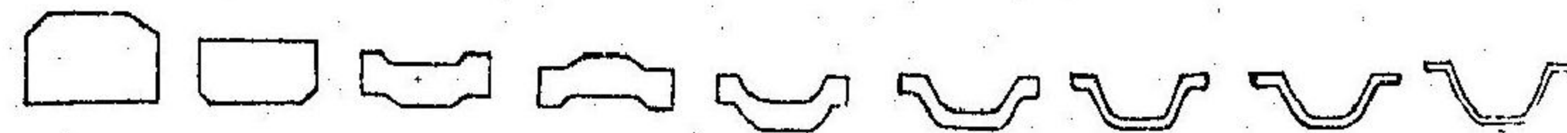
形の溝、上子輾用延壓鋼クラベ圖二十七第
